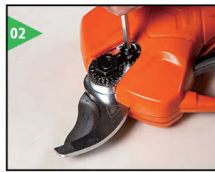
02. Entfernen Sie die Anti-Loose-Unterlegscheibenschrauben
